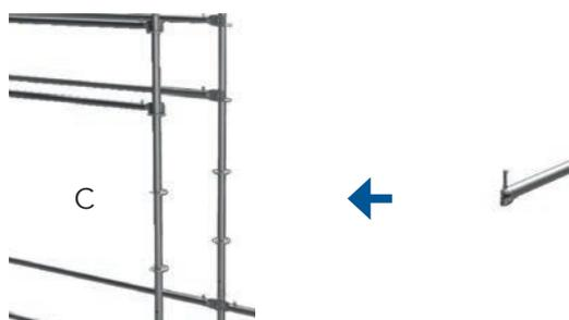
3. Après sécurisation par l'insertion d'un goujon de sécurité, le deuxième poteau vertical est posé (C) et la lisse est installée.
