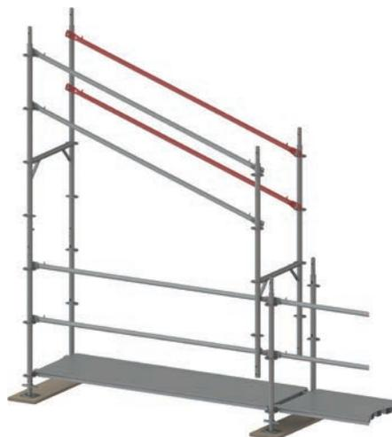
Figure 74 : Soulèvement du cadre en H avec garde-corps intérieur.
