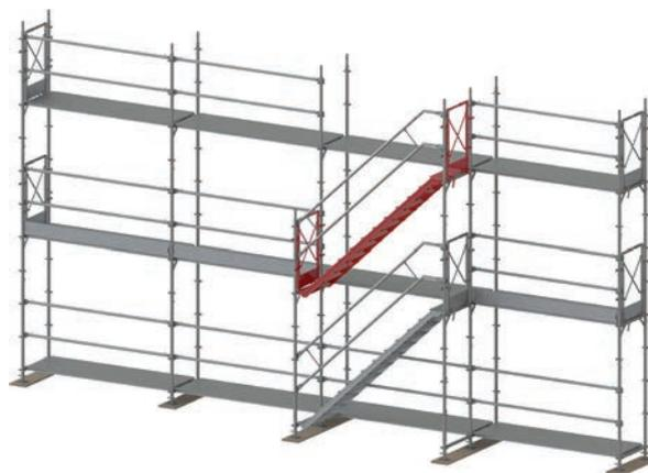
Figure 43 : Montage escalier et extrémité frontale.
