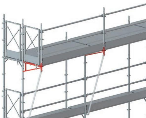
Figure 70 : Niveau d'échafaudage avec consoles extérieures et plateau.
