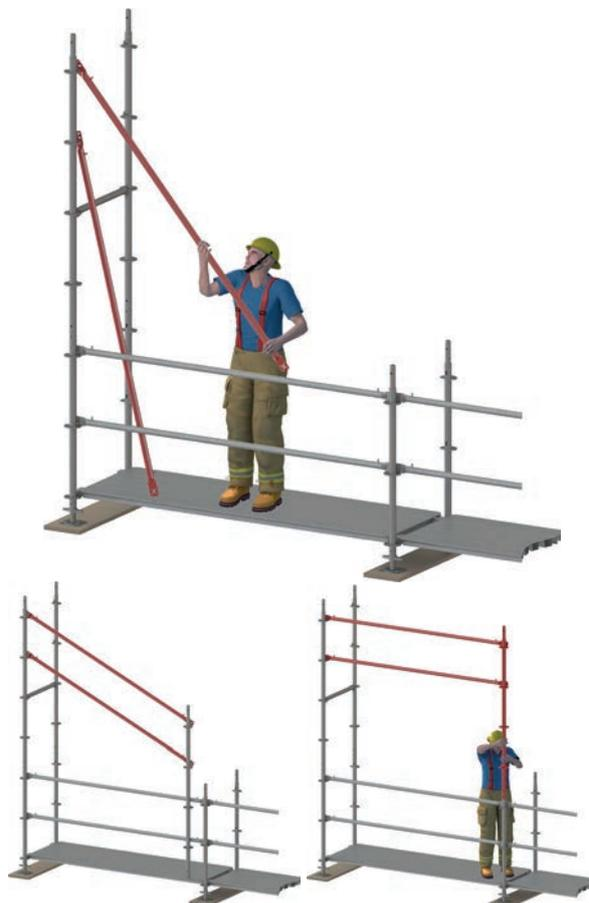
Figure 22 : Montage du renfort de garde-corps.
