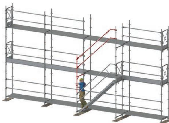
Figure 42 : Montage du cadre en T sur un poteau de garde-corps.
