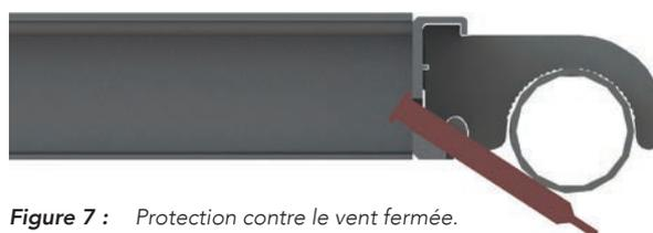
Figure 7 : Protection contre le vent fermée.
