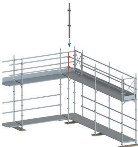
Figure 76 : Solution d'angle, garde-corps intérieur.
