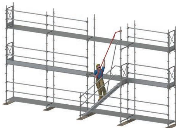
Figure 40 : Montage des mains courantes d'escalier.
