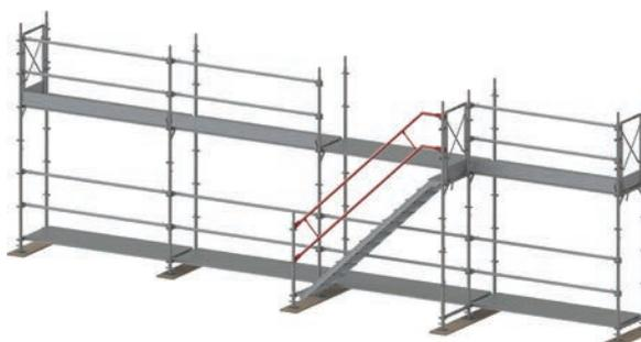
Figure 38 : Montage des mains courantes d'escalier terminé.
