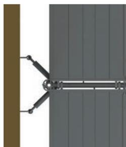
Figure 53 : Amarrage en V, configuration de base.
