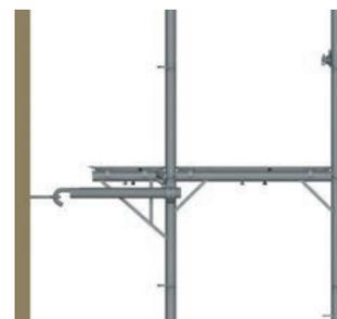
Figure 52 : Amarrage d'échafaudage, Configuration avec console intérieure.
