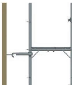
Figure 51 : Amarrage d'échafaudage, configuration de base.
