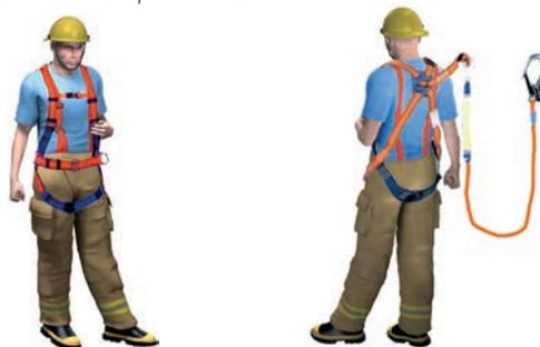
Figure 48 : Équipement de protection individuelle contre les chutes «EPlcC».
