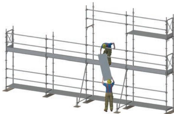
Figure 46 : Exemple d'une sécurité antibasculement temporaire du premier niveau de l'échafaudage.
